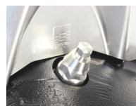
Dwa korki zalewowe znajdują się po obu stronach wsporników silnika dla EVMS32-90. Korek odpowietrzający jest zintegrowany z korkiem zalewowym
