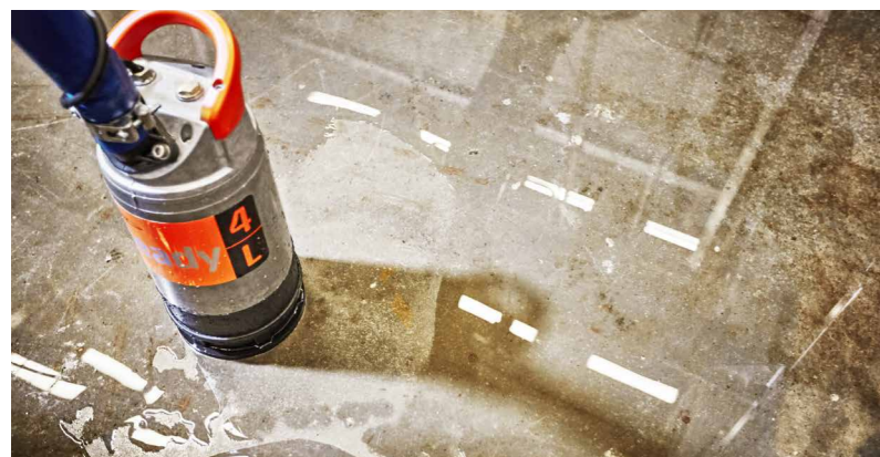
Wypompowuje wodę do poziomu 1-2 mm. Stojąc na płaskiej powierzchni: Hmax: 10,5 m oraz Qmax: 3,2 l/s.
